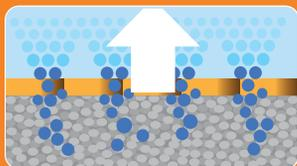
La capacità di assorbire l'umidità del DryGo! è 9,7 volte superiore a quella del poliuretano tradizionale (Test sviluppati secondo la normativa DIN EN 344-1).
